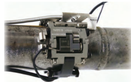
LPS с 32 элементами ФА датчиками
