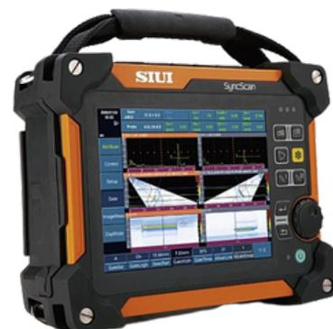
Ультразвуковой дефектоскоп SyncScan объединяет в одном корпусе: традиционный ультразвук (UT), метод фазированной решетки (PA), TOFD-метод, ультразвуковая толщинометрия (TG).
