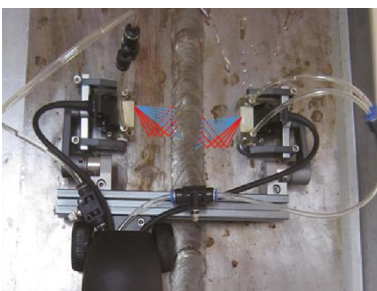
Контроль сварного шва с двух сторон
