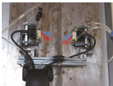
Контроль сварного шва с двух сторон
