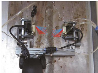
Контроль сварного шва с двух сторон
