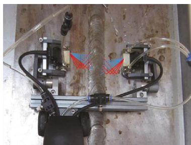
Контроль сварного шва с двух сторон
