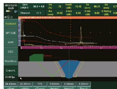
Измерение глубины залегания дефекта
