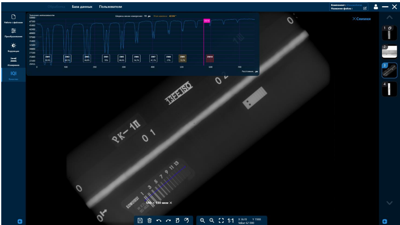
Измерение базового пространственного разрешения
