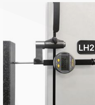
Электронный индикатор для измерения перпендикулярности
